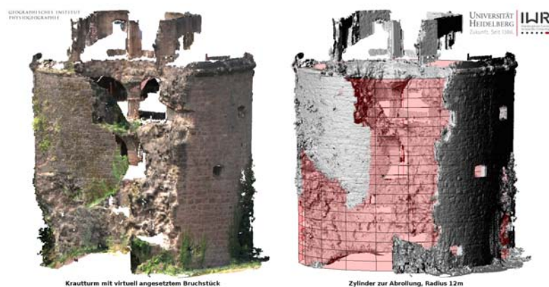
3D-Modell des Pulverturms am Heidelberger Schloss, basierend auf TLS-Daten sowie Pulverturm mit eingesetztem Bruchstück.
